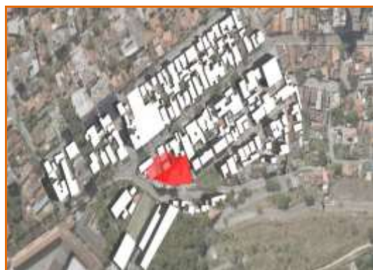
Figura 51: Simulação do sombreamento no mês de dezembro às 8:00 horas e 15:00 horas da tarde.
