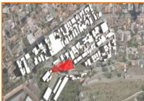
Figura 48: Simulação do sombreamento no mês de março às 8:00 horas da manhã e 15:00 horas da tarde.
