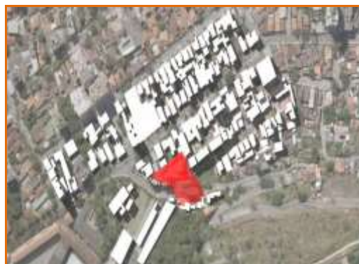
Figura 49: Simulação do sombreamento no mês de Junho às 8:00 horas da manhã e 15:00 horas da tarde.
