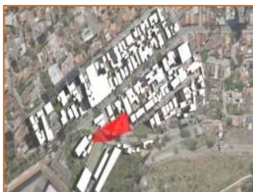
Figura 50: Simulação do sombreamento no mês de setembro às 8:00 horas da manhã e 15:00 horas da tarde
